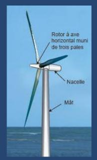
Grâce au vent, le rotors se met en marche et les pales tournes.
